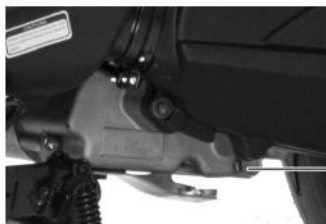
Vite di drenaggio (2)
